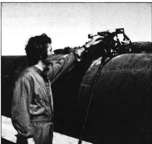
På rørledningerne til naturgassystemet er det af stor vigtighed, at alle dårlige svejsninger er fundet, inden rørene bliver gravet ned. Her kontrolleres svejsesømmen med ultralyd.
